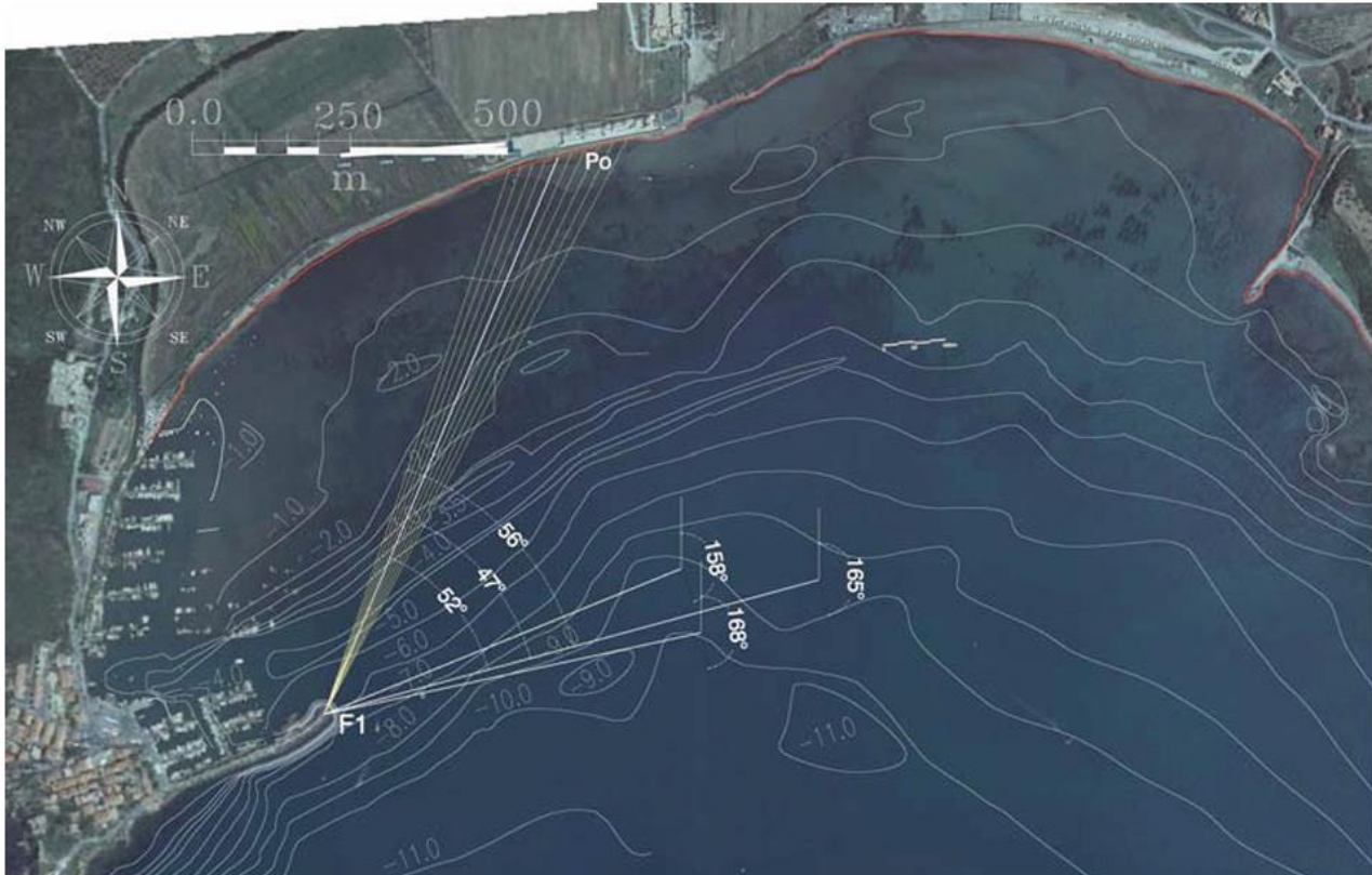
Figura 13. Direzioni d'onda e linee di controllo per il tracciamento delle linee di riva teoriche del macromodello su aerofoto del 2012 e curve batimetriche
